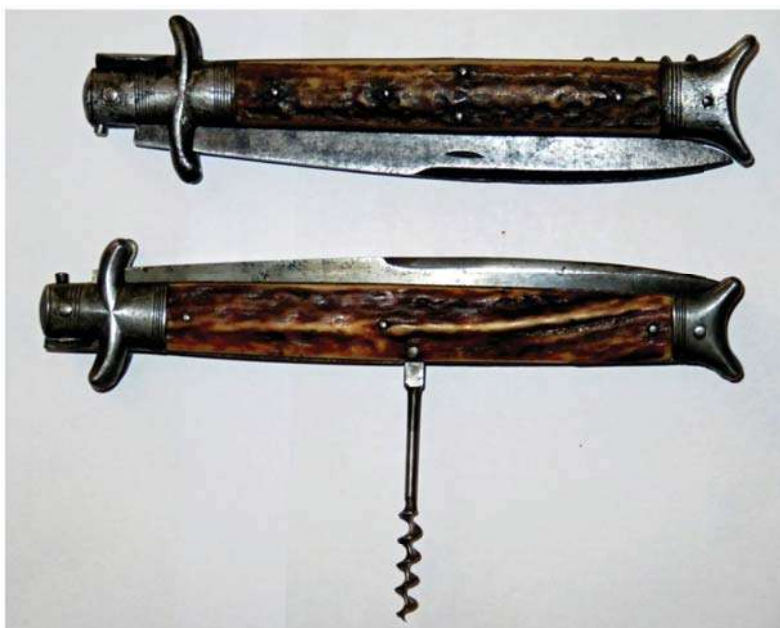
Due coltelli-pugnali con guance in corno e terminali in acciaio. Il cavatappi è costituito da un fusto a sezione rotonda e vite forgiata, che ripiegata si nasconde nel coltello.
